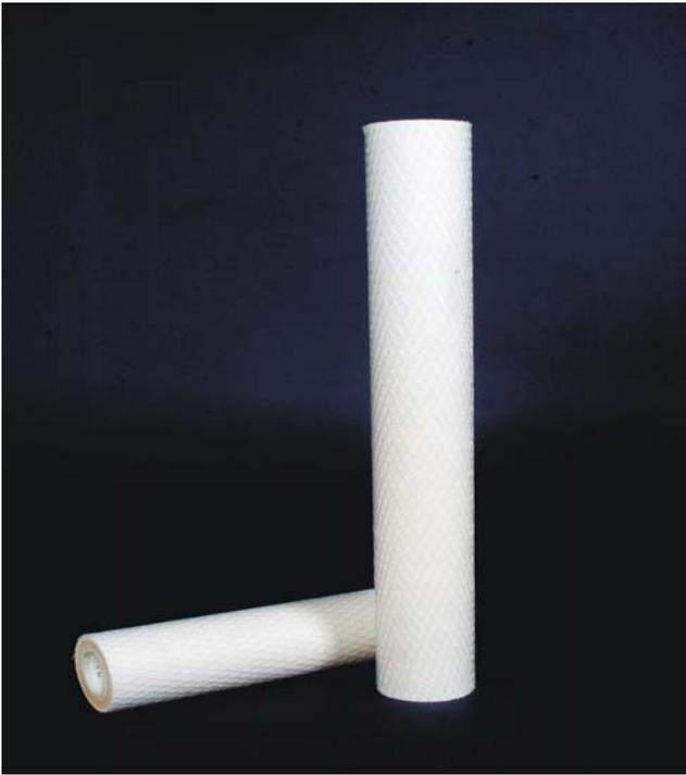
RD-KLEAN 필터 카트리지는 부직포 방식의 필터로 Rayon Media 와 내열 Core를 사용하여 사용 온도가 높은 곳이나 PP재질을 사용할 수 없는 공정에 매우 적합한 필터입니다. 제거능이 약 98% 내외로 Semi-Absolute Type Filter입니다.
